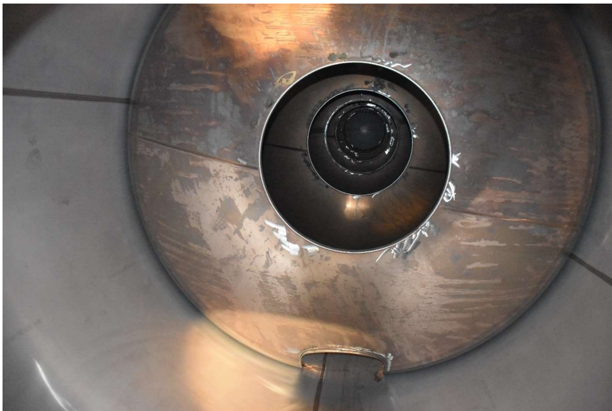
Figur 13. Bild tagen genom manluckor i främre gavel på skvalpskotten och de öppningar som möjliggör för vätska att rinna mellan skotten.
