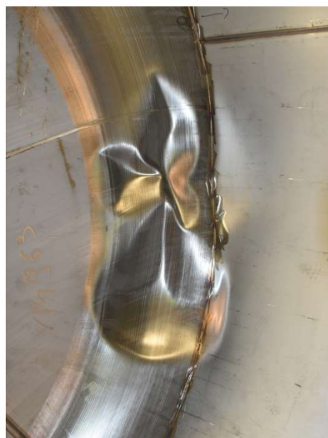
Figur 20. Bild tagen på yttertanken kort efter att trailern bärgats. Deformerade områden syns på den främre gaveln på både inner- och yttertanken. Bild från innertanken är tagen senare på verkstad.
