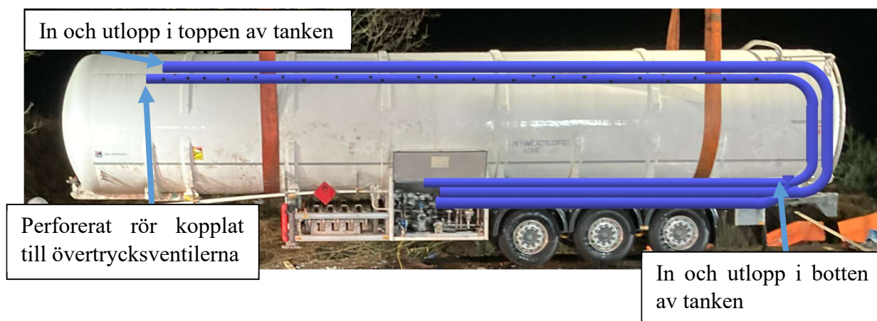
Figur 14. Schematisk bild av in- och utlopp från innertanken samt rör till övertrycksventilen.
