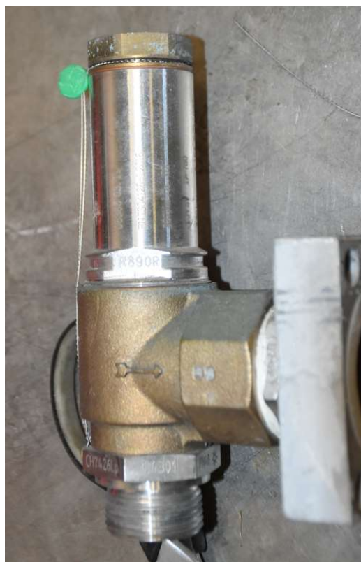
Figur 15. Bild samt sprängskiss av övertrycksventil.
