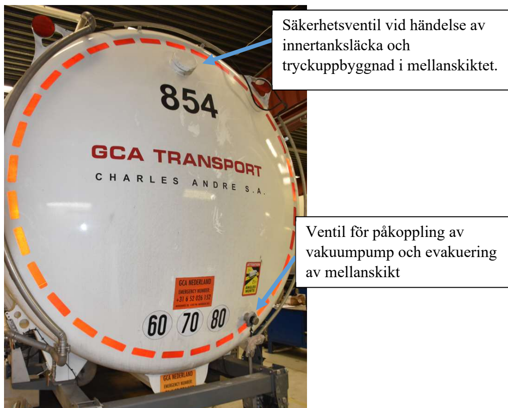
Figur 12. Placering av ventiler för vakuumpump samt övertrycksventil.
