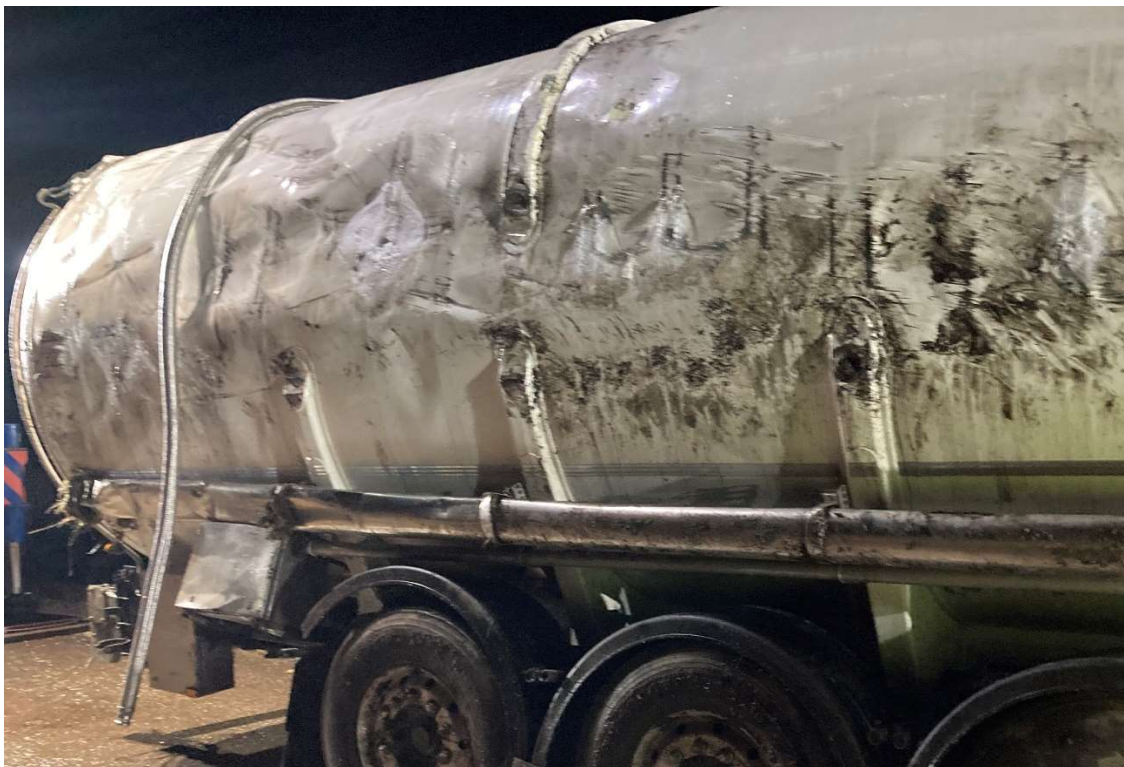
Figur 21. Bild tagen efter att trailern bärgats. Deformerade områden på den bakre högra långsidan framgår.
