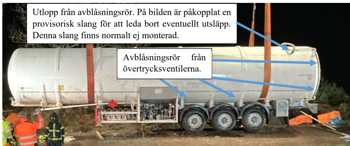
Figur 16. Placering av avblåsningsrör från övertrycksventilerna.
