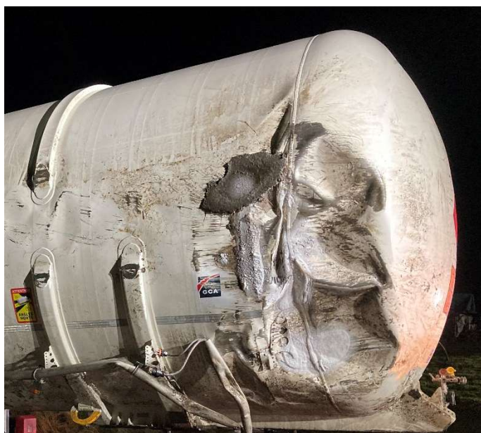
Figur 20. Bild tagen på yttertanken kort efter att trailern bärgats. Deformerade områden syns på den främre gaveln på både inner- och yttertanken. Bild från innertanken är tagen senare på verkstad.
