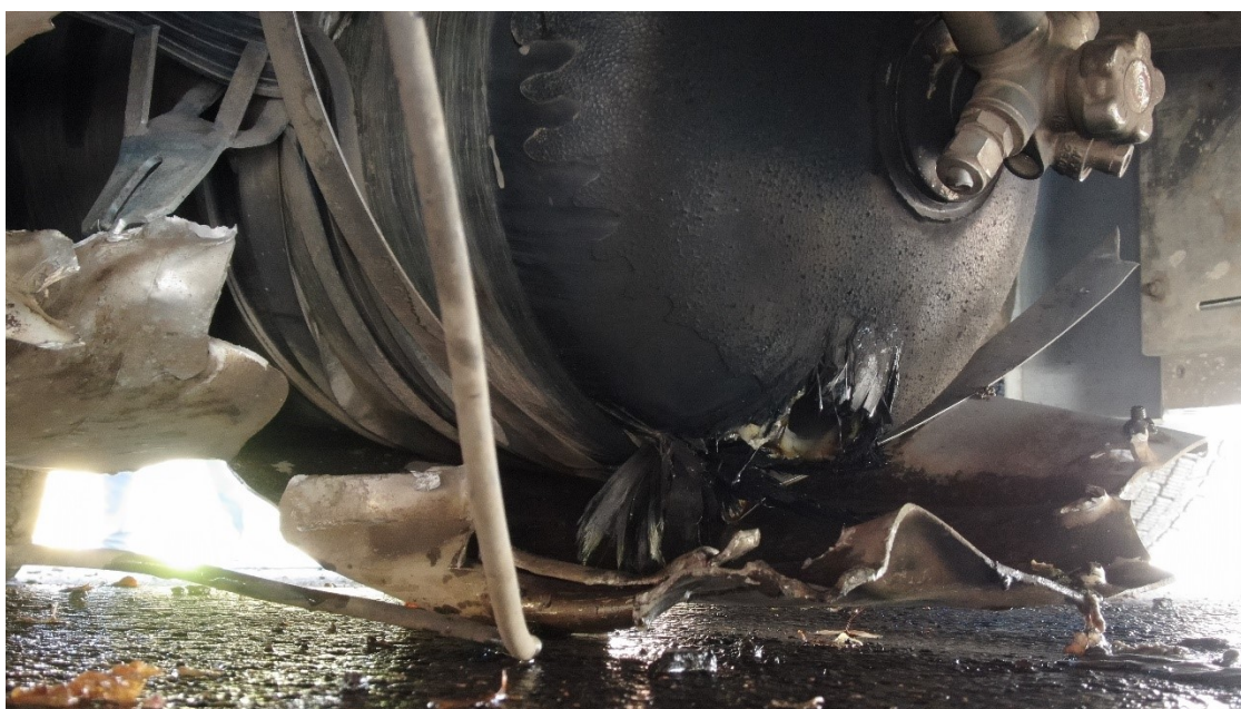
Figur 5. Närbild på gastankens skador.
