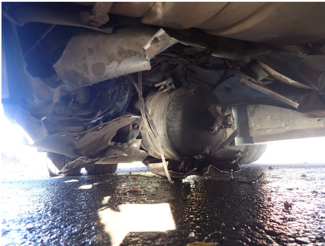
Figur 4. Skador på gastanken samt skyddsplåten och upphängningsanordningen.
