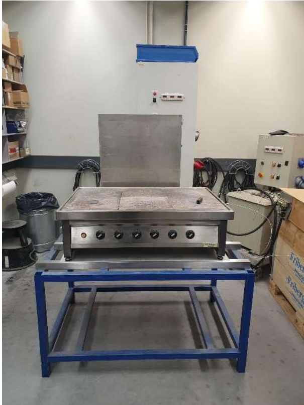
Figur 10. Försökupställning för temperaturmätning.
