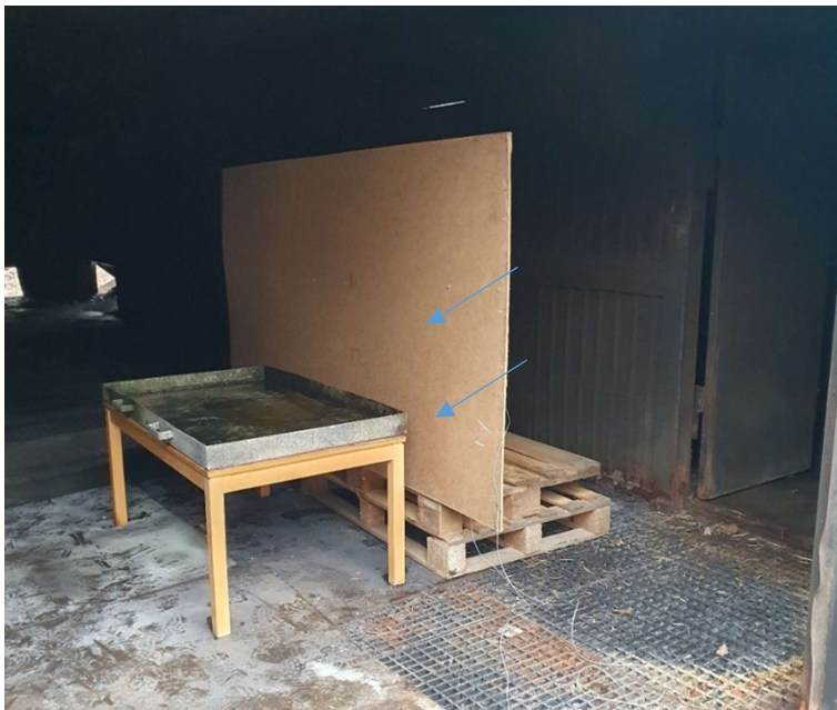
Figur 15. Försöksuppställning vid brandförsök.
