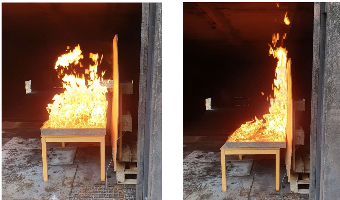
Figur 16. Säkerhetsavstånd mellan kärl och vägg tv. och dikt an mot vägg t.h.
