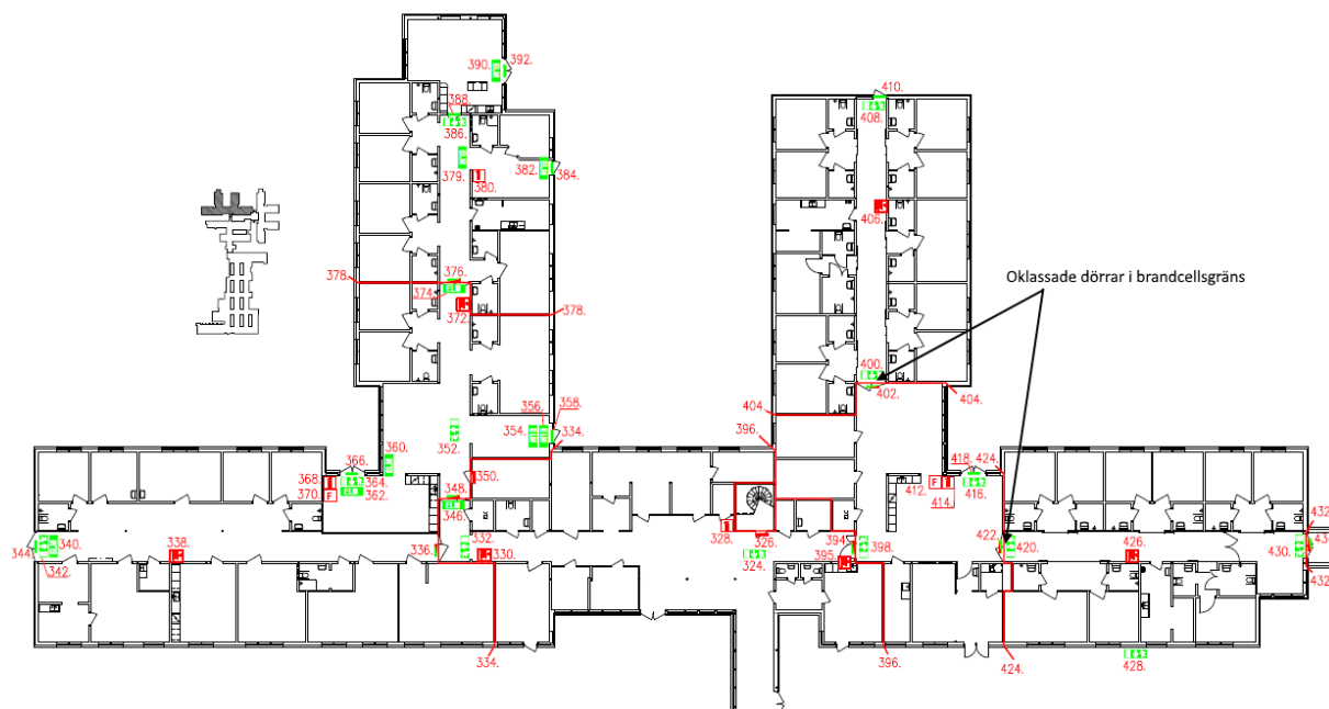
Figur 10. Ritning som förtydligar de noterade bristerna vid korttidsboendet. Källa SBA-ritning
